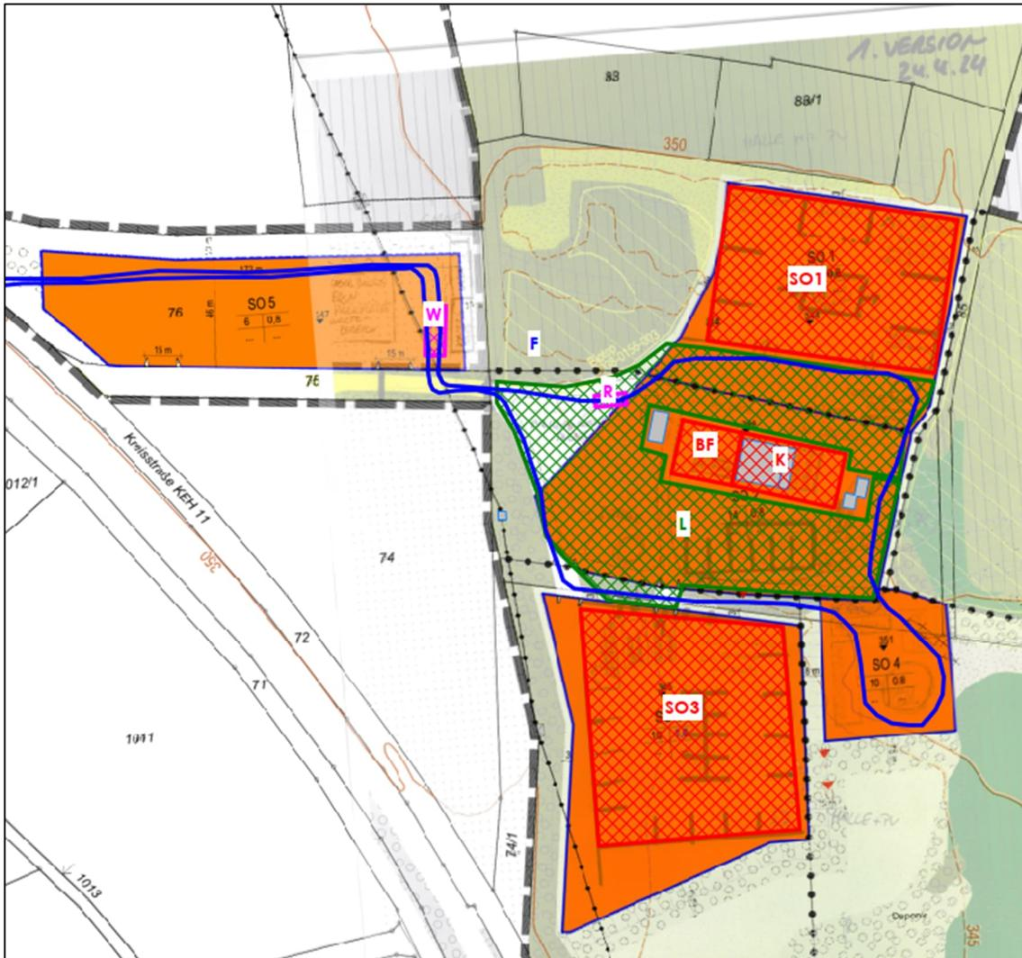
Abbildung 6: Lageplan mit Planskizze und Darstellung der berücksichtigten Schallquellen /8, 11/
